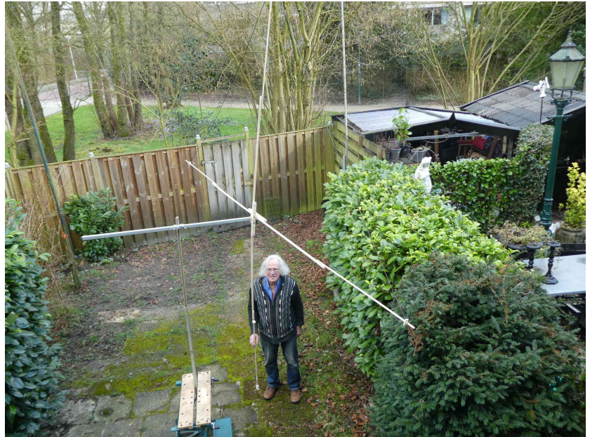
Reflector frame met 10 m draad in een vierkant
